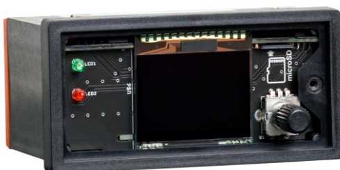
Abbildung 4: EOR-1DS mit abgeschraubter Frontplatte für Zugang zur SD-Karte
